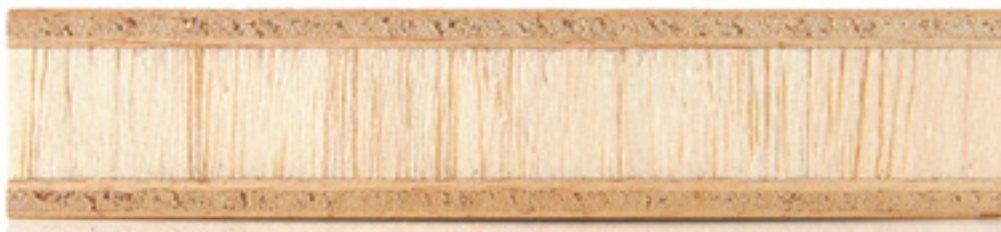
■ Dettaglio della struttura sandwich del pannello Balsapan / Detail of the Balsapan panel sandwich structure.
